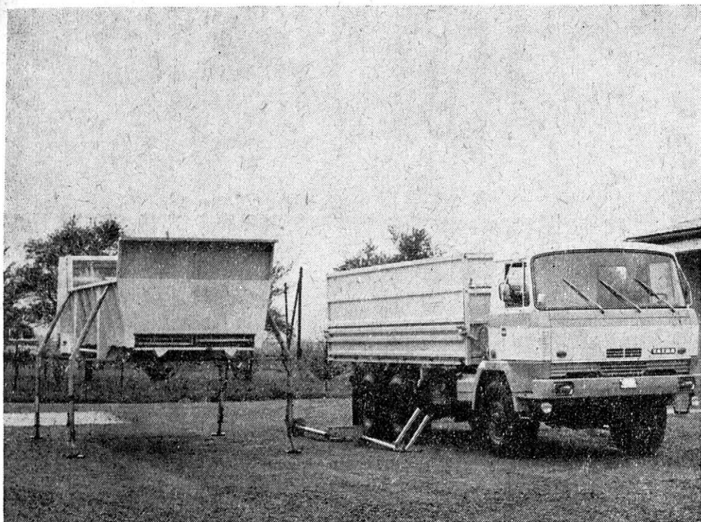
3. Zemědělský nákladní automobil Tatra 815 Agro s výměnnými nástavbami (sklápeč s objemovou nástavbou, rozmetadlo chlévského hnoje)
