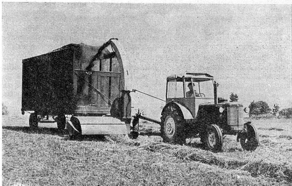
1. Kombinovaný cepový sklízeč SPKZ - 160 s velkoobjemovým přívěsem 45 m 3 při sklizni zvalé píce
