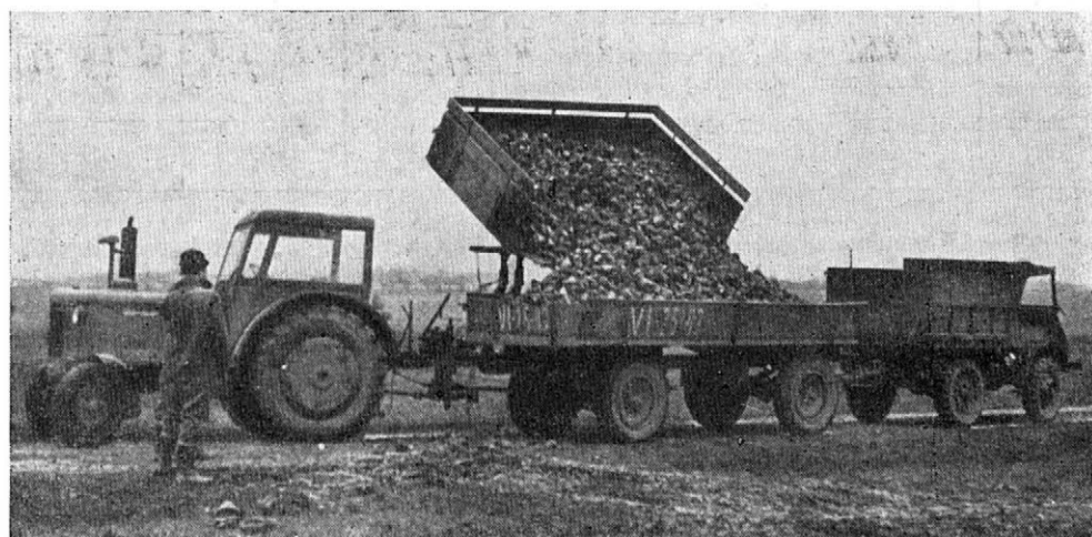
4. Překládání cukrovky vysokozdvížným návěsem na silniční dopravní prostředky. Návěs má hnanou nápravu a dobré jízdní vlastnosti v terénu
